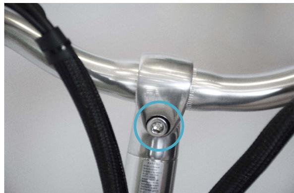
Parafuso de ajuste da inclinação do guidão
